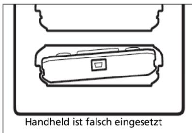
Wenn sich in einer Docking-Station 10 Handhelds befinden, wiegen sie zwischen 4,5 und 5,5 kg. Benutzen Sie immer beide Hände, wenn Sie eine Docking-Station transportieren. Wenn Sie die Docking-Station zu weit kippen, können die Handhelds herausfallen.
