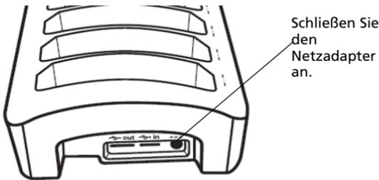
Wenn Sie mehrere Docking-Stationen verwenden, um Akkus aufzuladen oder Dateien zu übertragen, müssen Sie jede Docking-Station an eine Steckdose bzw. an eine Steckdosenleiste anschließen.
