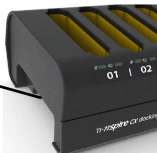
Wenn Sie die Docking-Station umdrehen, sehen Sie eine Einbuchtung bzw. einen „Kanal“ auf der Unterseite. Um sicherzustellen, dass die Docking-Stationen flach auf der Unterlage liegen, führen Sie das Kabel durch diesen Kanal, wenn Sie mehrere Docking-Stationen hintereinander anordnen. Verwenden Sie den Kabelaufwickler, um nicht benötigte USB-Kabellängen unterzubringen.
