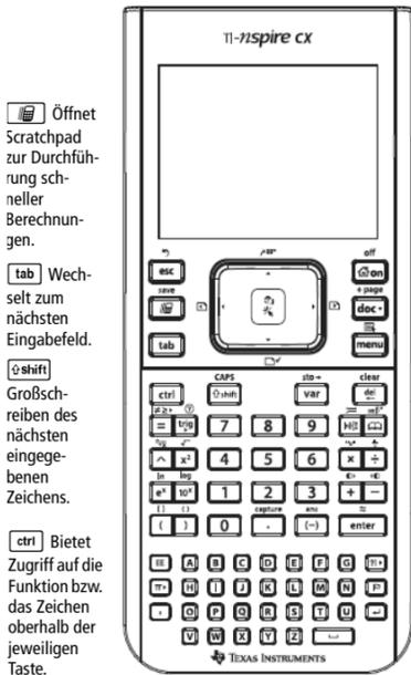
**[on]** Einschalten des Handheld. Wenn das Handheld bereits eingeschaltet ist, öffnet diese Taste den Hauptbildschirm.
